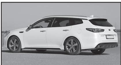
Габаритные размеры составляют 4855 мм в длину, 1860 мм в ширину и 1465 мм в высоту. Колесная база, растянутая до 2805 мм, позволила добавить пространства для ног задних пассажиров. В целом салон удалось сделать более просторным во всех направлениях по сравнению с предыдущим поколением модели. При этом коэффициент лобового сопротивления удалось довести до 0.29.
