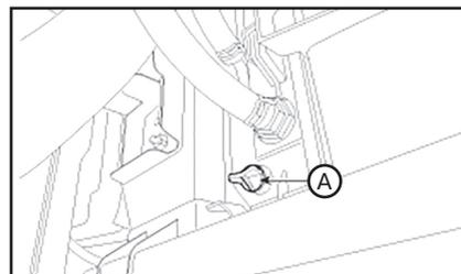
5. Надежно затяните сливную пробку радиатора.
