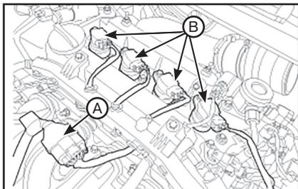
4. Снимите катушки зажигания (А).
